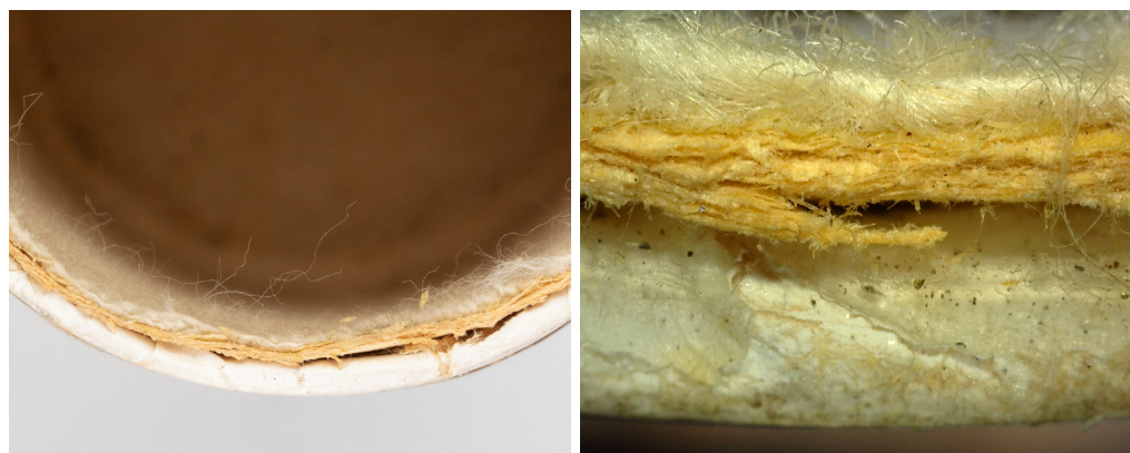
Obr. 3. Ochranný tubus série Edison Goldguss Walze (1902–12) se dvěma vrstvami lepenky a navazující bavlněnou výstelkou. Makroskopická fotografie (a) a mikroskopický snímek (b), obojí foceno v kolmém pohledu a dopadajícím bílém světle.
