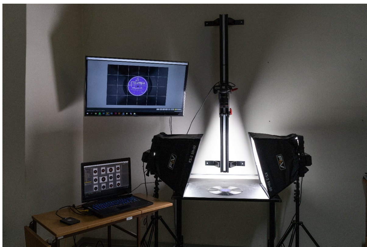
Fotoreprodukční soustava digitalizačního pracoviště NM-ČMH.
